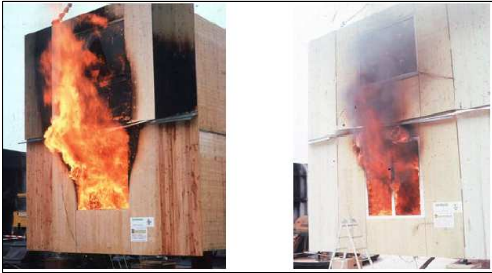
Figur 2: Billedet viser hvorledes røg og flammer spredt sig ud af vinduet i forbindelse med brand i to forskellige forsøgsopstillinger. I forsøgsopstillingen til venstre har de indvendige væg- og lofts en overflade af træ. I forsøgsopstillingen til højre har de indvendige væg- og lofts ubrændbare overflader. Ved brandforsøgene, hvor rummenes geometri og brandbelastning var ens, sås væsentligt højere flammer ud af vinduerne fra venstre prøveopstilling med overflader af træ. "Fire Performance of Timber Structures under Natural Fire Conditions", Andrea Frangi and Mario Fontana, Institute of Structural Engineering IBK, Swiss Federal Institute of Technology ETH Zurich
